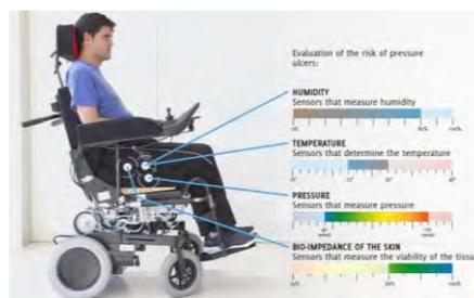
Fig.1. Sistema inteligente de prevención de UPPs incorporado a la silla de ruedas electrónica. El sistema permite la monitorización continua de la presión de apoyo, la temperatura y la bioimpedancia.
