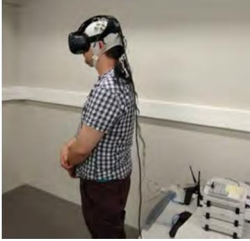
Fig. 1. Sujeto de pruebas llevando a cabo la creación del modelo. En la imagen se puede ver el equipo actiCHamp y el sistema HTC Vive.
