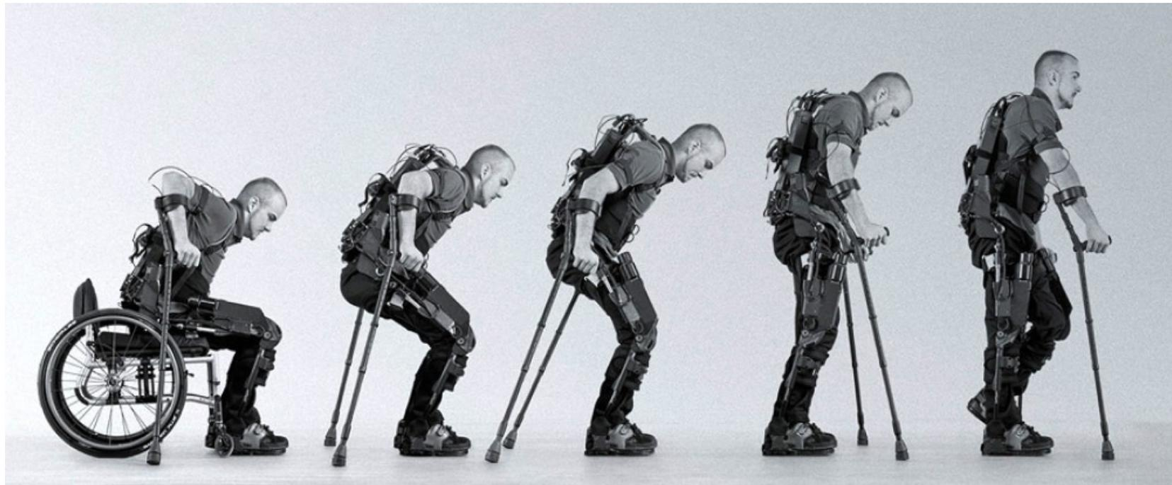
Un dispositivo compuesto por una ortesis externa motorizada empleada con propósitos clínicos que se coloca en una persona que presenta parálisis de sus extremidades para facilitar la deambulaci3n (FDA, HHS 2015)
